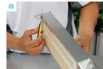
㉓ 乾燥した後ではフィルムが水糊により接着され切り落としづらくなります。
