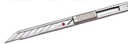
デザインナイフの定番。刃は先端のネジをゆるめて差し込み、固定するだけ。ぐらつくかず、安定した切味なので、アートワークや切り絵などの繊細な切り抜きに最適です。
