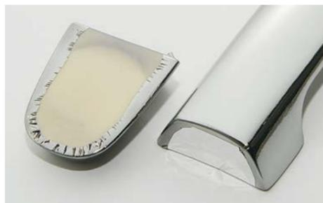
ABS樹脂製のドアハンドル模型にモデリングシートクロームシルバーを貼り込んだ使用例。柔軟なフィルム特性により、三次曲面への追従性が優れています。
