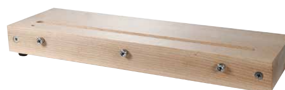
ヘラ研ぎ台（後面） スチール板 固定ボルト 3カ所
